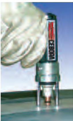
**POWER PULLER ALUMINIUM** (art. 1288) foi projectado para aplicações específicas em alumínio. Consiste num sistema de macaco mecânico, que permite a tracção do parafuso de
