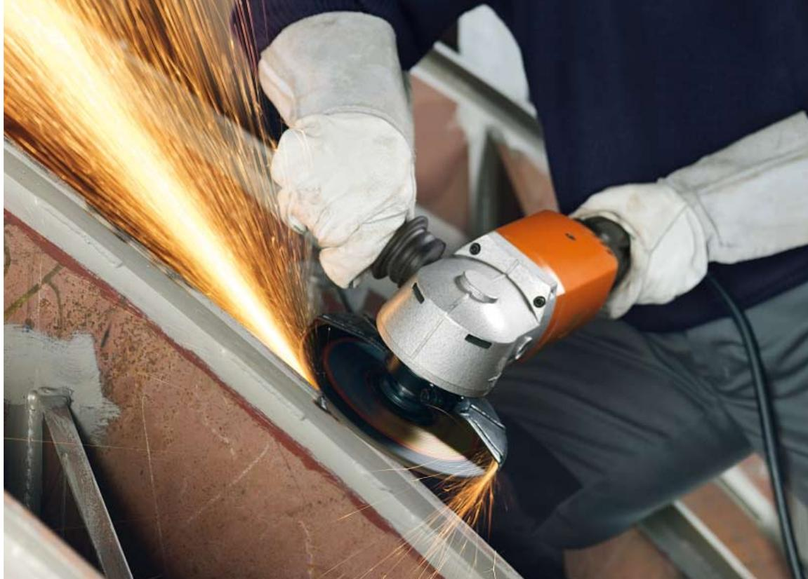
Las amoladoras angulares FEIN de alta frecuencia destacan por sus velocidades estables y su rendimiento. Ventajas: elevada potencia para un desbaste constante con poco desgaste del disco!
