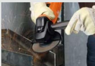
Elimine fácilmente y sin generar residuos rebabas en los cantos de piezas de trabajo con mecanizado grueso.
